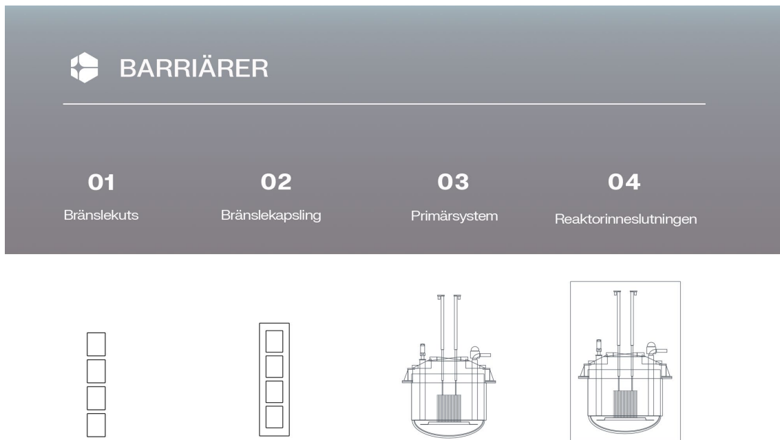
Figur 3-2. Principskiss som illustrerar de fysiska barriärstegen.
